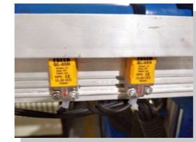
电磁感应开关, 控制运动模块行程 Electromagnetic flowmeter, control run unit
